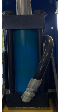
Cilindro idraulico e fissaggio al corpo macchina
