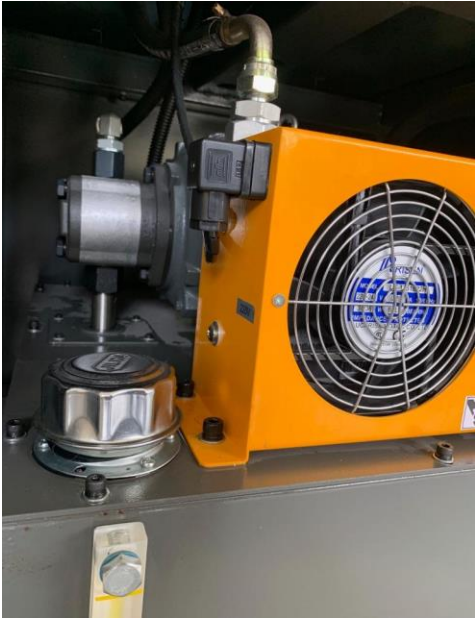
Limitatore di potenza massima indipendente dall'operatore Sistema di raffreddamento impianto idraulico.
