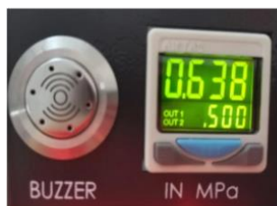
Sensore acustico che avvisa caso di pressione aria non idonea e/o mancanza di rivetto
