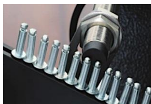
Sistema di alimentazione con sensore di presenza rivetto
