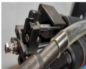
Tubo di alimentazione rivetto posizionato sulla pistola di rivettatura
