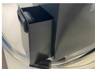
Sistema di recupero del chiodo, quest'ultimo viene raccolto in un contenitore all'interno della macchina
